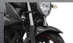
BARRAS TELESCÓPICAS FRONTALES DE 41 MM DE DIÁMETRO
